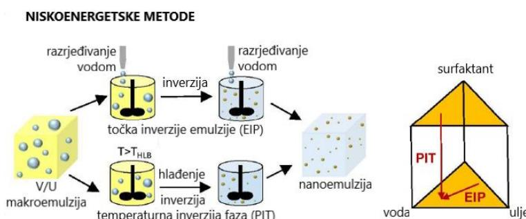
Slika 6. Shematski prikaz izrade nanoemulzija niskoenergetskim metodama (preuzeto i prilagođeno iz (Gupta i sur., 2016)).
