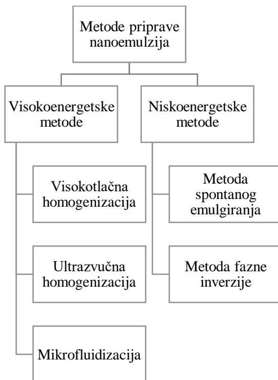
Slika 3. Shematski prikaz metoda priprave nanoemulzija.
