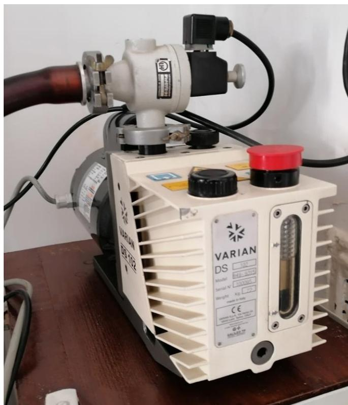
**Slika 14.** Vakuumpumpa Varian DS 102, model 949-9315 stvara vakuum do  $10^{-3}$  bara.
