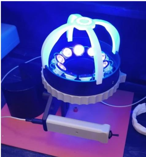
**Slika 19.** UV lampa. Bijela konstrukcija na vrhu lampe je 3D printani stalak za NMR cijevčice.
