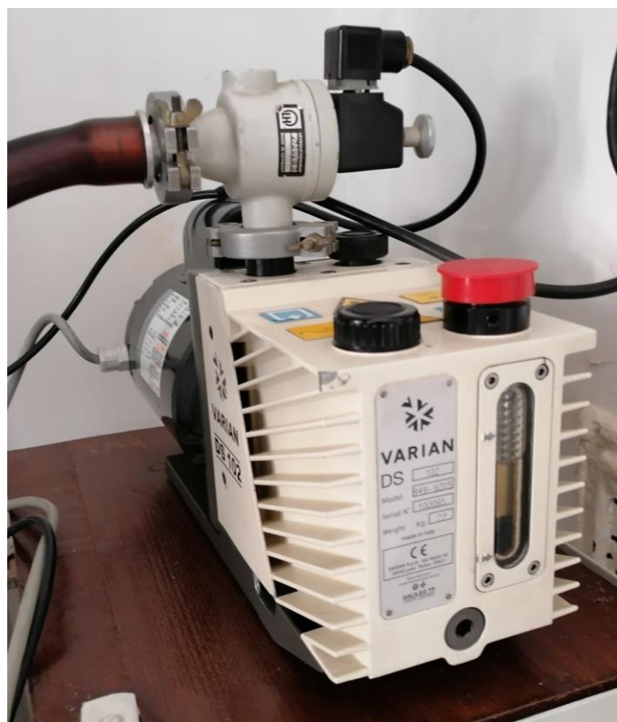
Slika 14. Vakuumpumpa Varian DS 102, model 949-9315 stvara vakuum do 10^{-3} bara. Sastavni je dio aparature za otplinjavanje otapala.
