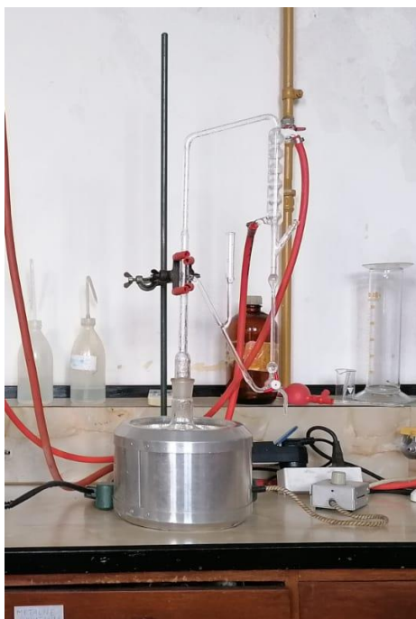
Slika 8. Aparatura za određivanje eteričnog ulja na Zavodu za farmakognoziju, Farmaceutsko-biokemijskog fakulteta Sveučilišta u Zagrebu
