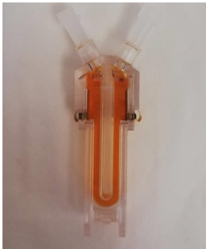
Slika 11. Kiveta DTS1070 za mjerenje zeta potencijala napunjena uzorkom (Fotografija snimljena tijekom izvođenja eksperimentalnog dijela diplomskog rada)
