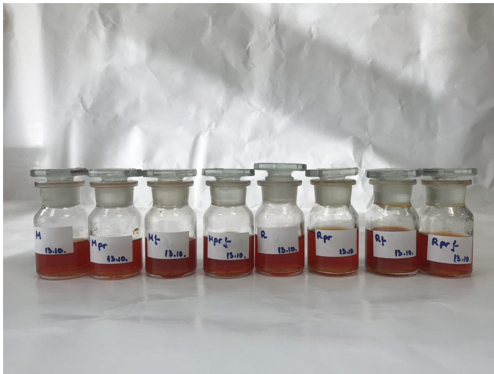
Slika 10. Uzorci nanoselena spremni za analize (Fotografija snimljena tijekom izvođenja eksperimentalnog dijela diplomskog rada)
