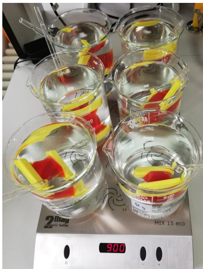
Slika 9. Dijaliza otopina nanoselena na magnetskoj miješalici (Fotografija snimljena tijekom izvođenja eksperimentalnog dijela diplomskog rada)
