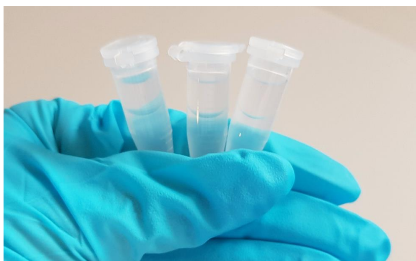
Slika 9. Centrifugirane Eppendorf epruvete s odijeljenim gornjim vodenim slojem u kojem je otopljen piocijanin.
