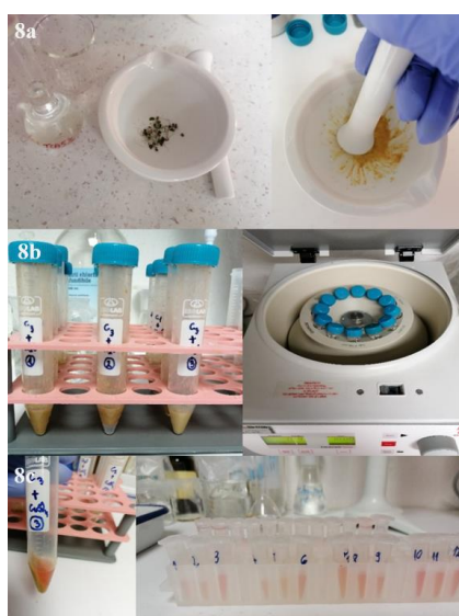
Slika 8. Koraci pripreme homogenata biljnog tkiva rotkvice: a – homogenizacija, b – centrifugiranje, c – odvajanje supernatanta
