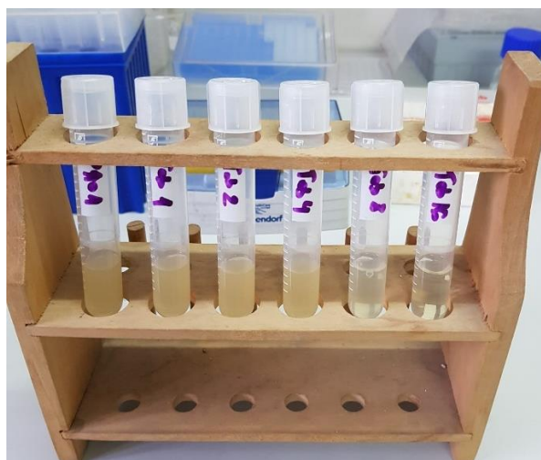
Slika 13. Određivanje minimalne inhibitorne koncentracije tobramicina metodom serijskog razrjeđenja praćenjem замуćenja otopina različitih koncentracija tobramicina (s lijeva na desno 1 mg/L, 2 mg/L, 4 mg/L, 8 mg/L i 16 mg/L) u odnosu na netretiranu kulturu (prva epruveta).
