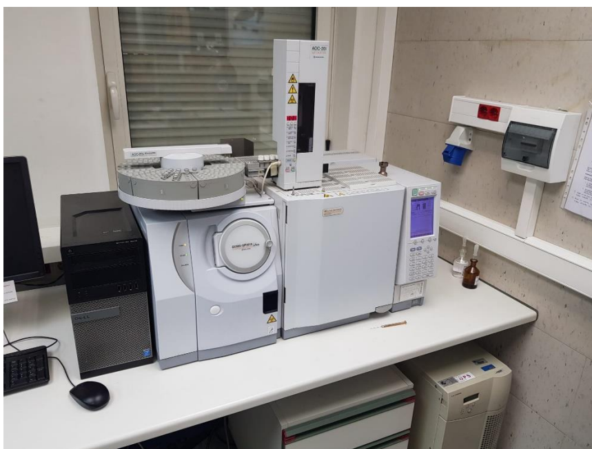
Slika 10. GC-MS-QP2010 Ultra, Shimadzu, Centar za forenzična ispitivanja, istraživanja i vještačenja „Ivan Vučetić“.
