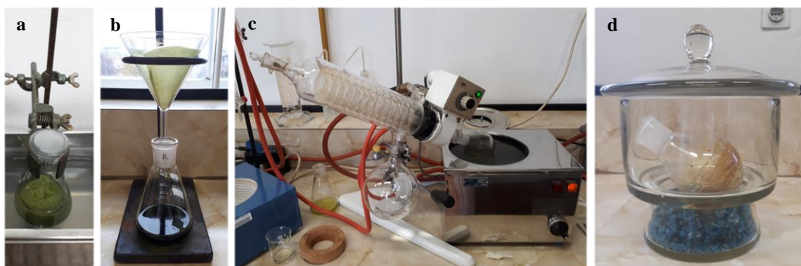
Slika 10. Priprema etanolnog ekstrakta: ekstrakcija u ultrazvučnoj kupelji (a), filtracija (b), uparavanje pomoću rotacijskog vakuum-uparivača (c), sušenje ekstrakta u eksikatoru (d)
