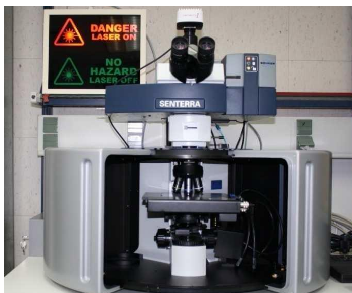
Slika 7. Ramanov disperzivni spektrometar SENTERRA u konfiguraciji s Olympus mikroskopom.
