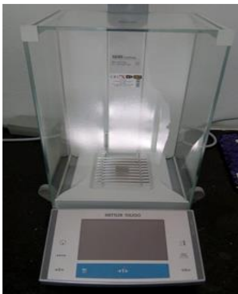
Slika 6. Analitička vaga Mettler Toledo XA105DU
