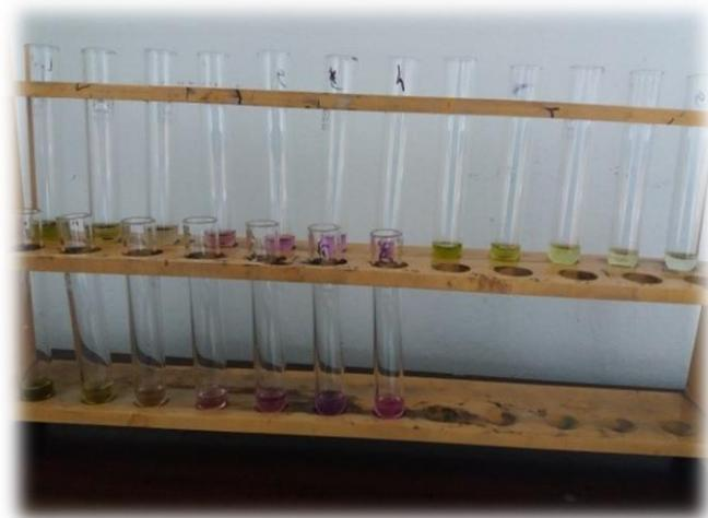
**Slika 16.** Određivanje sposobnosti keliranja iona željeza (II)
