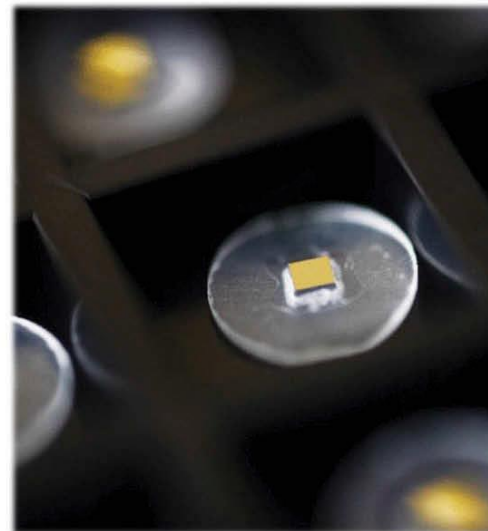
Slika 4. Shematski prikaz i fotografija probavljivog digitalnog senzora (preuzeto iz Plowman i sur., 2018)
