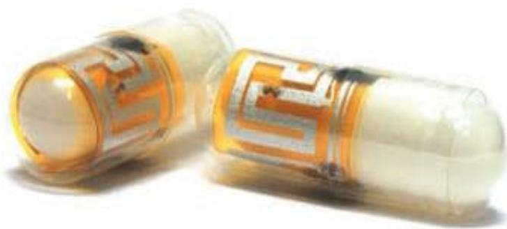
Slika 10. ID-kapsula – standardna kapsula s ugrađenim probavljivim bežičnim senzorom (preuzeto iz Flores i sur., 2016)
