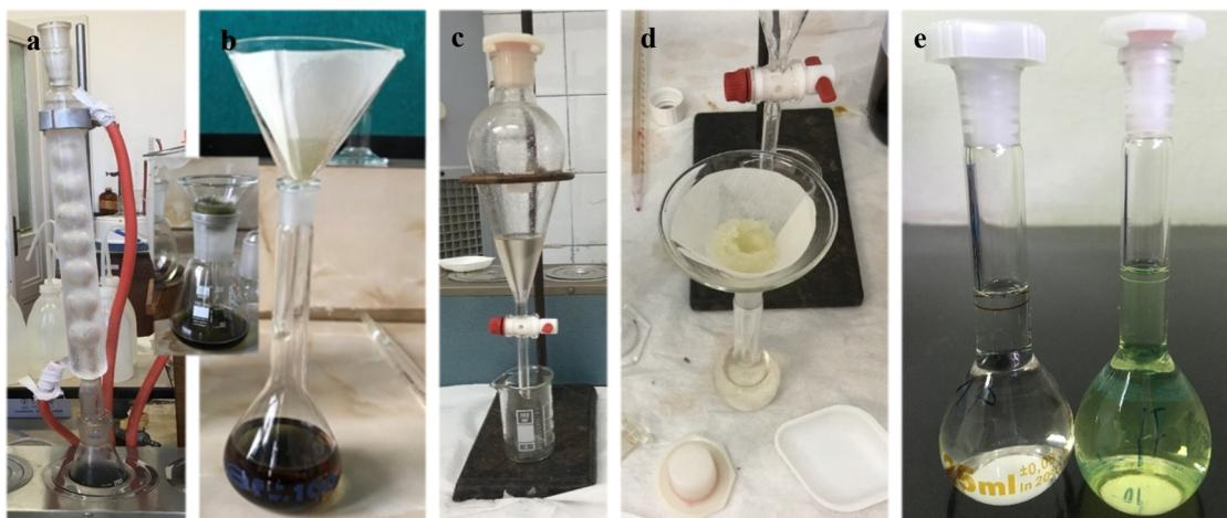
**Slika 7.** Određivanje flavonoida: ekstrakcija na vodenoj kupelji uz povratno hladilo (a), priprema acetonskog ekstrakta (b), izmućkavanje s etil-acetatom u lijevku za odjeljivanje (c), filtracija preko bezvodnog natrijevog sulfata (d), poredbena i ispitivana otopina (e)
