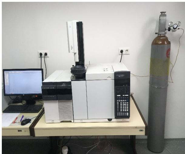
**Slika 9.** Spregnuti sustav plinske kromatografije sa spektrometrijom masa
