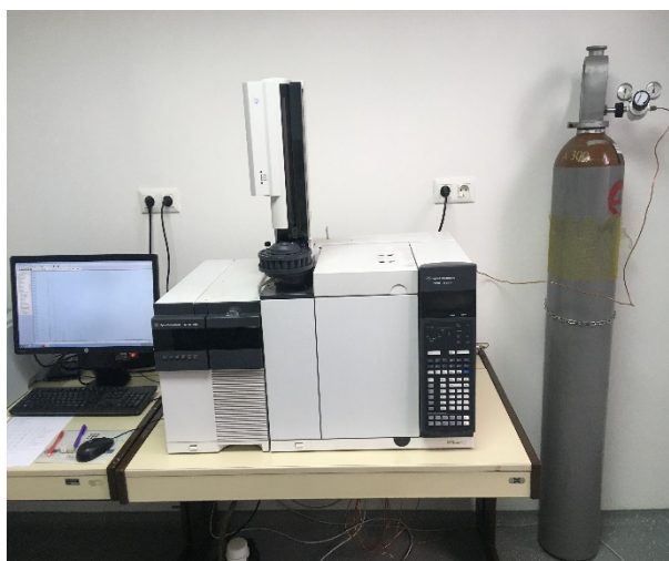
Slika 9. Spregnuti sustav plinske kromatografije sa spektrometrijom masa
