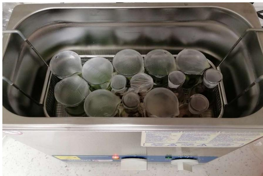
Slika 14. Ultrazvučna ekstrakcija uzorka drijena
