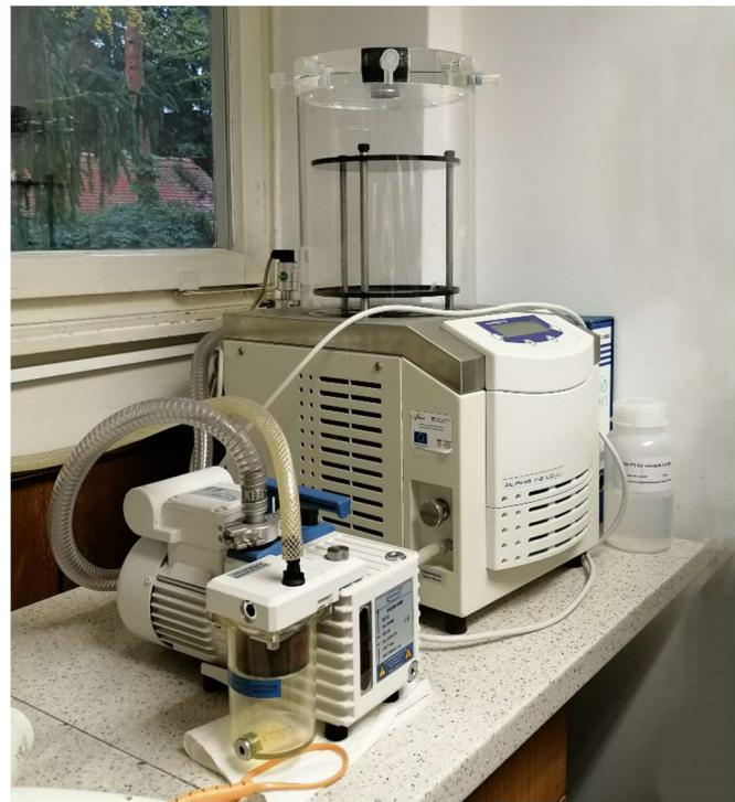
Slika 6. Liofilizator Alpha 1-2 LDplus
