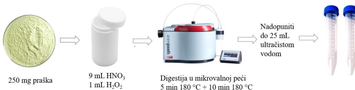
Slika 10. Priprema uzoraka mikrovalnom digestijom (EPA 3052).
