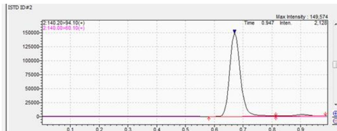
Slika 4: Kromatogram internog standarda homocisteina
