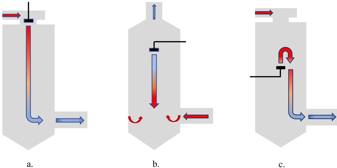
**Slika 3.** Shematski prikazi a. istosmjernog (engl. *co-current*), b. protusmjernog (engl. *counter-current*) i c. kombiniranog (engl. *combined*) načina sušenja raspršivanjem. Izrađeno pomoću PowerPoint programa i prilagođeno prema Cal i Sollohub, (2009).
