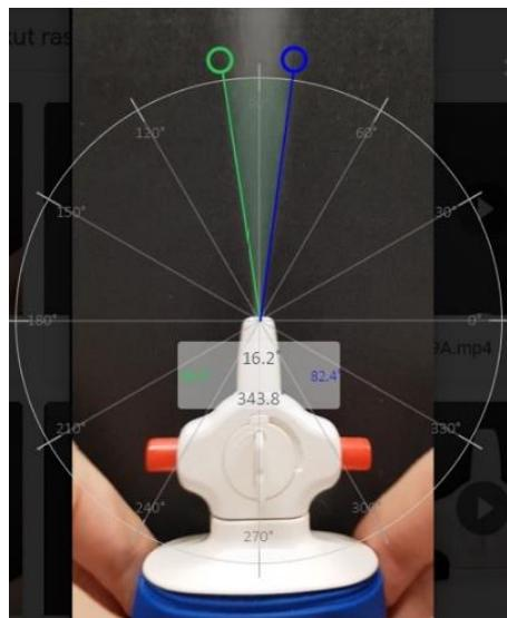
**Slika 5.** Mjerenje kuta raspršenja virtualnim kutomjerom
