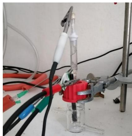
**Slika 14.** Elektrokemijska ćelija korištena u elektrokemijskim mjeranjima spojeva 1-30
