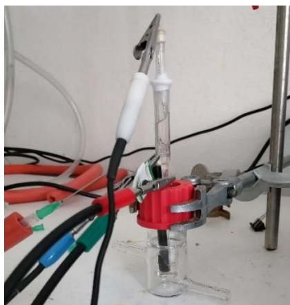
Slika 14. Elektrokemijska ćelija korištena u elektrokemijskim mjerenjima spojeva 1-30
