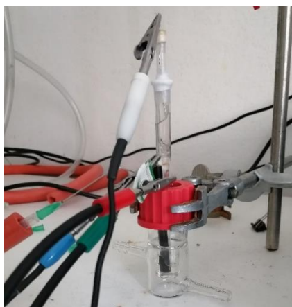
Slika 14. Elektrokemijska ćelija korištena u elektrokemijskim mjerenjima spojeva 1-30
