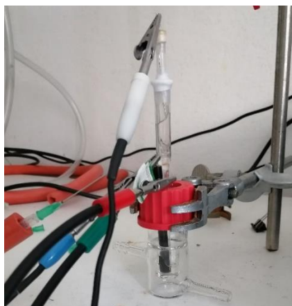
Slika 14. Elektrokemijska ćelija korištena u elektrokemijskim mjerenjima spojeva 1-30
