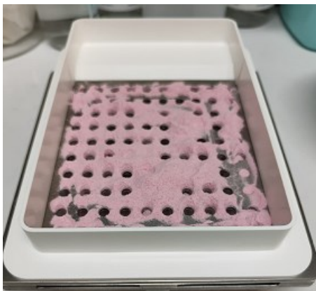
Slika 9. Punjenje kapsula homogenom smjesom prašaka propranolola
