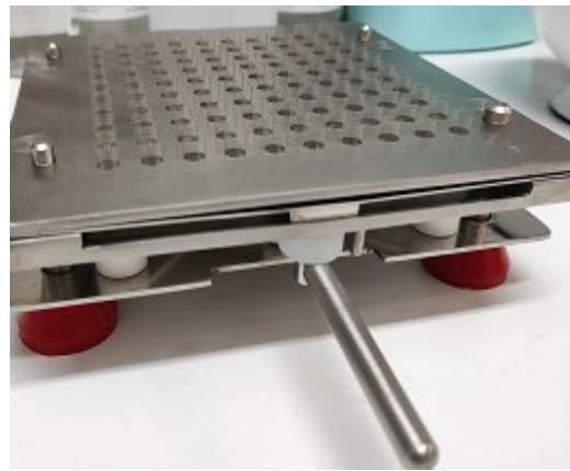
Slika 8. Razdvajanje (otvaranje) praznih kapsula
