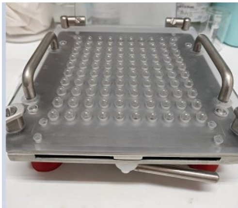
Slika 8. Razdvajanje (otvaranje) praznih kapsula
