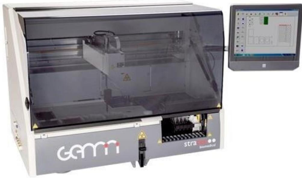
*Slika 3. Gemini analizator tvrtke Stratec. Instrumenti sadržani u analizatoru su: mikropipete, ELISA inkubator, ELISA sustav za ispiranje (engl. ELISA washer), ELISA sustav za očitavanje (engl. ELISA reader) i računalni zaslon, preuzeto s <https://www.medicaexpo.com/prod/diatron/product-68218-803353.html>*
