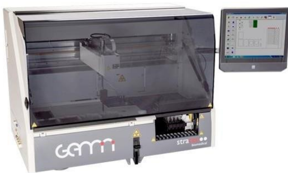
Slika 3. Gemini analizator tvrtke Stratec. Instrumenti sadržani u analizatoru su: mikropipete, ELISA inkubator, ELISA sustav za ispiranje (engl. ELISA washer), ELISA sustav za očitavanje (engl. ELISA reader) i računalni zaslon, preuzeto s https://www.medicalexpo.com/prod/diatron/product-68218-803353.html
