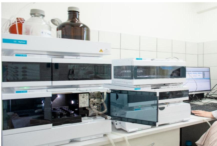
Slika 9. Tekućinski kromatograf visoke djelotvornosti s detektorom s nizom dioda
