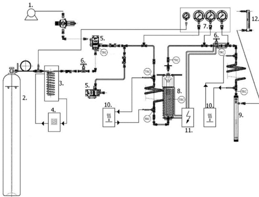
Slika 7. Shematski prikaz uređaja za superkritičnu ekstrakciju (80)
