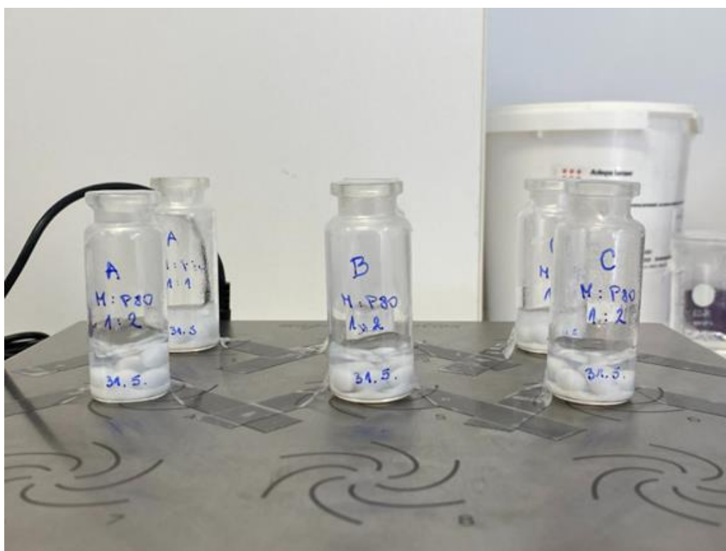
Slika 1. Prikaz pripreve nanosuspenzija melatonina metodom vlažnog mljevenja
