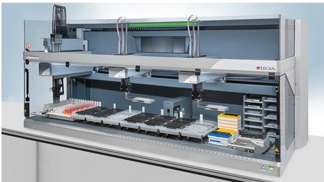
**Slika 9.** – Tecan FreedomEvo automatizirani sustav za tekućinsku manipulaciju i robotiku
