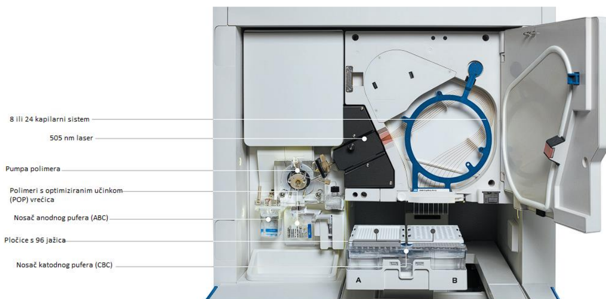
Slika 11. – Dijelovi korištenog xCGE-LIF uređaja
