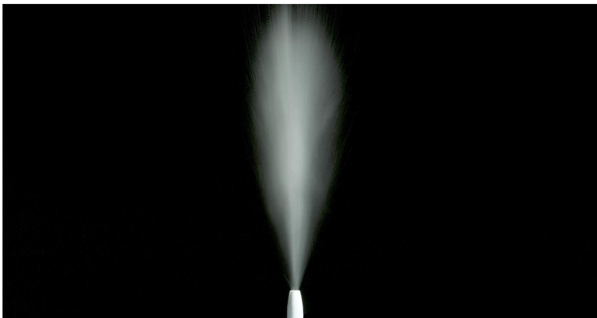
Slika 21. Slika ekstrahirana iz video zapisa raspršivanja uzorka mikrosfera DoE 15 iz UDSP uređaja. Uz dozvolu Elseviera preuzeto i prilagođeno iz Perkušić i sur. (2022) (251).
