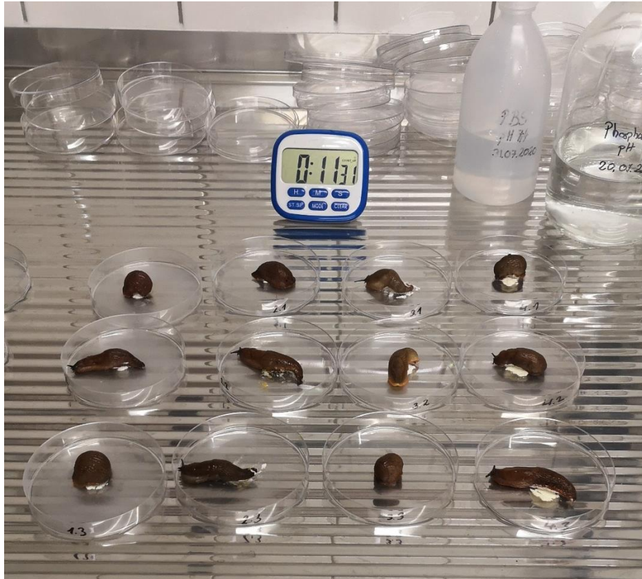
Slika 27. Utvrđivanje iritacijskog potencijala praškastih uzoraka pomoću testa irtacije sluznice puža golaća in vivo .
