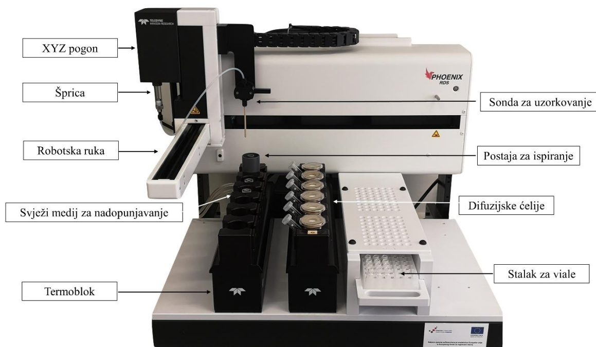
Slika 17. Automatizirani sustav Franzovih difuzijskih ćelija Phoenix TM RDS (Teledyne Hanson, SAD).
