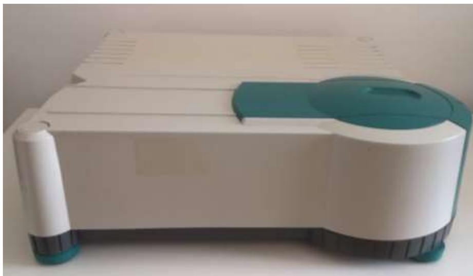
Slika 7. UV-Vis spektrofotometar Cary 50 Probe (Varian, SAD)
