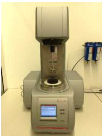
Slika 8. Reometar MCR 102 (Anton Paar GmbH, Austrija)
