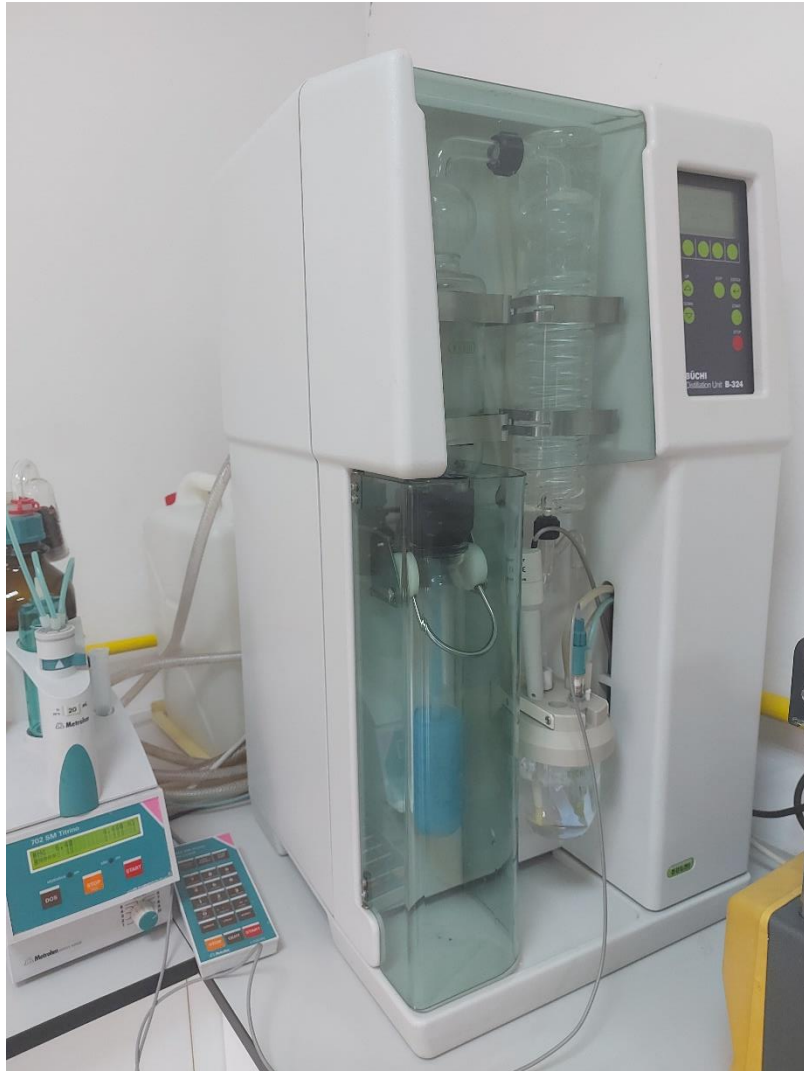
Slika 6. Automatska neutralizacija, destilacija i titracija
