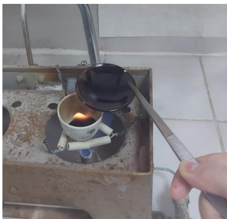
Slika 2. Postupak spaljivanja na plameniku u užarenom lončiću
