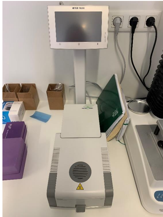
Slika 7. Halogeni vlagomjer (Mettler Toledo, model HX204)
