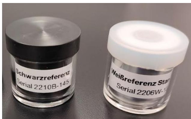
Slika 5. Prikaz crnog i bijelog standarda potrebnog za referentna mjerenja
