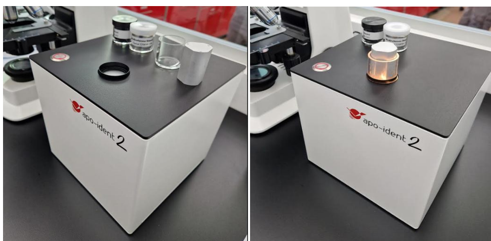
Slika 7. Prikaz referentnih standarda i transfleksivnog umetka za mjerenje te samo mjerenje glicerola s transfleksivnim umetkom
