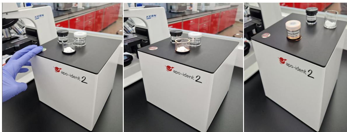
Slika 4. Prikaz mjerenja ispitivane farmaceutske sirovine eritromicina i referentnog mjerenja bijelim standardom
