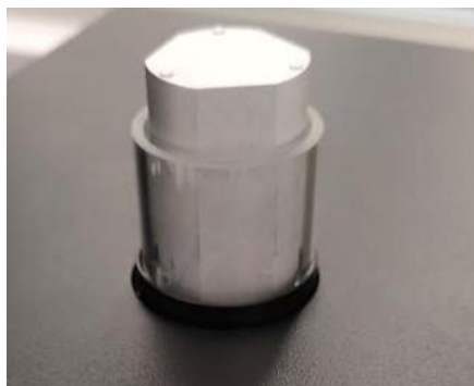
Slika 6. Transfleksivni umetak u mjernoj posudici i crni mjerni prsten koji olakšava fiksiranje mjerne posude na mjerni prozorčić
