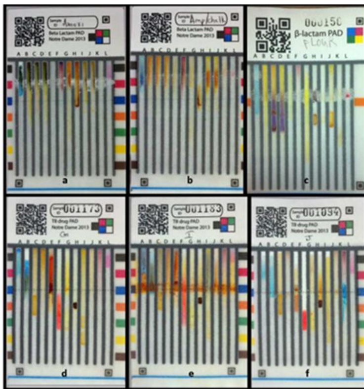
Slika 15 – Rezultati analize papirnim testnim karticama za neke beta-laktamske antibiotike i antituberkulotike ( preuzeto i prilagođeno prema literaturnom navodu 63. )
