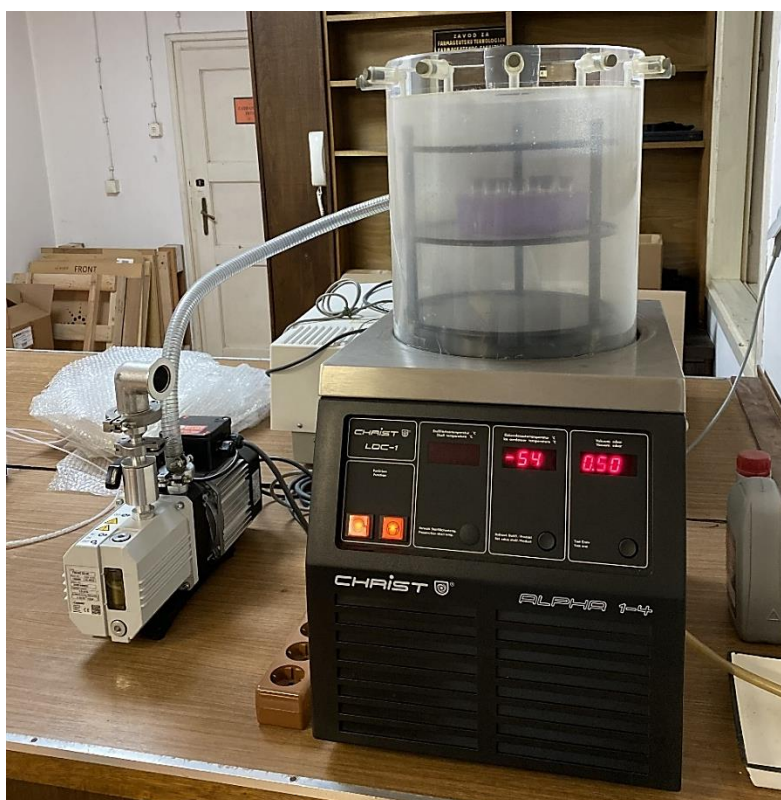
Slika 9. Sušenje uzoraka u Alpha 1-4 liofilizatoru (Martin Christ, Njemačka)
