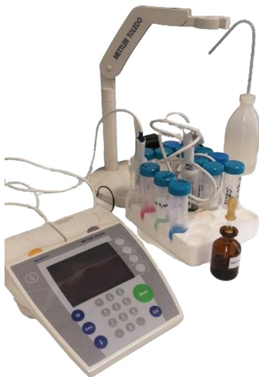
Slika 7. pH metar S47 SevenMulti (Mettler-Toledo, Švicarska)
