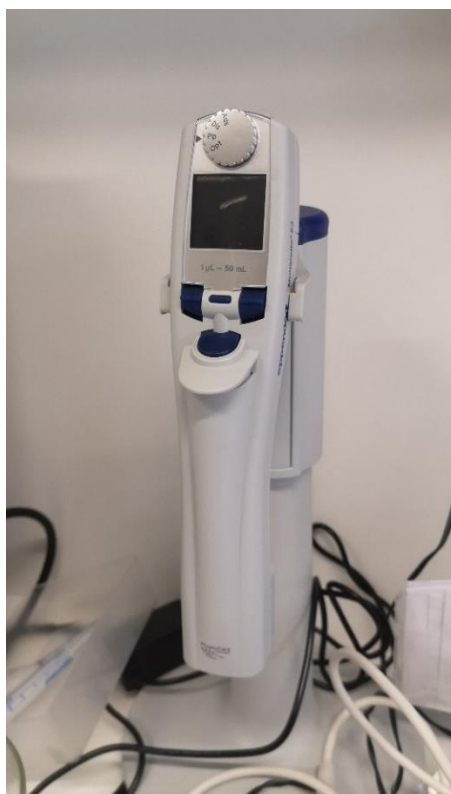
Slika 9. Pipeta za viskozne uzorke Multipette E3 (Eppendorf, Njemačka)
