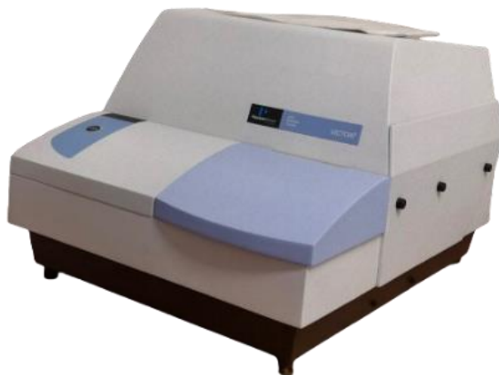
Slika 11. Čitač mikrotitrskih pločica Victor3 (PerkinElmer, Sjedinjene Američke Države)
