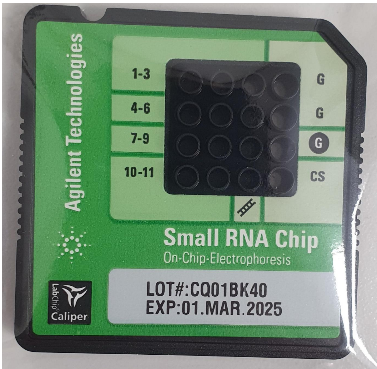
Slika 5. Mikrotekućinski čip za analizu sRNA na Agilent 2100 Bioanalyzer uređaju pomoću Agilent Small RNA kompleta.
