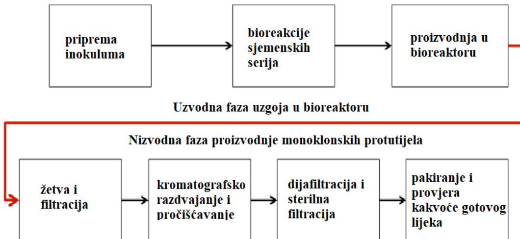
Slika 9: Prikaz uobičajene proizvodnje monoklonskih protutijela. U uzvodnoj fazi se u bioreaktoru uzgajaju stanične linije, a njihovim rastom eksprimiraju proteini, dok se u nizvodnoj fazi protein od interesa izolira i pročišćava do finalnog proteinskog lijeka (preuzeto i prilagođeno iz (50)).
