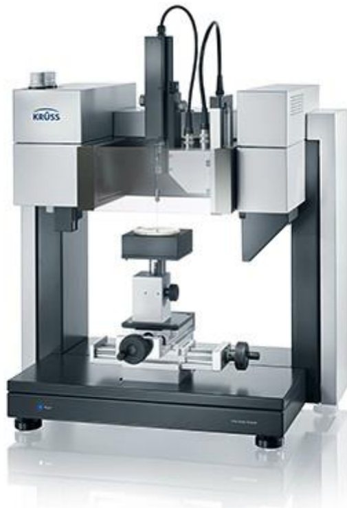
Slika 12. Instrument za mjerenje kuta močenja DSA100 (Krüss)
