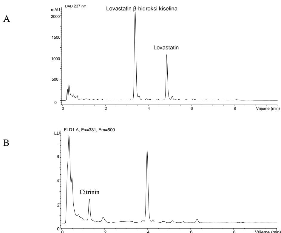
**Slika 46.** Kromatogram smjese standarda lovastatina, lovastatin  $\beta$ -hidroksi kiselina i citrinina pri optimiziranim uvjetima HPLC-DAD-FLD-MS<sup>n</sup> metode. (A) DAD detektor, (B) FLD detektor
