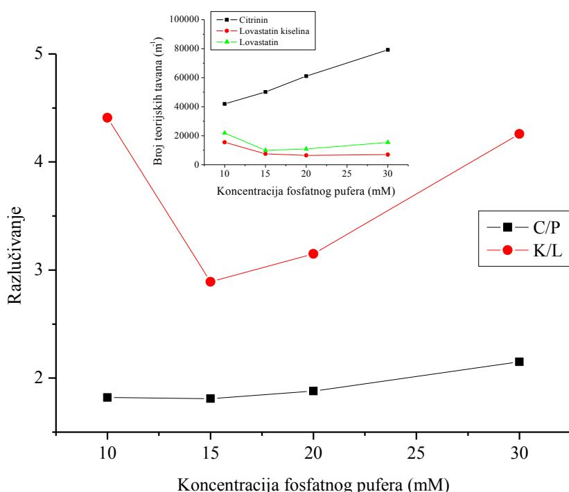
**Slika 40.** Ovisnost razlučivanja između analita o koncentraciji fosfatnog pufera. Umetak slići: Ovisnost broja teorijskih tavana o koncentraciji fosfatnog pufera.
