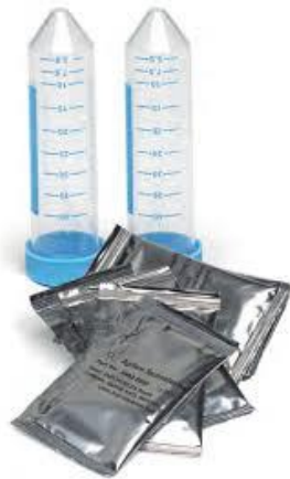
Slika 2. QuEChERS oprema sastoji se od tuba, soli u bezvodnom obliku i otapala za čvrsto faznu ekstrakciju.
