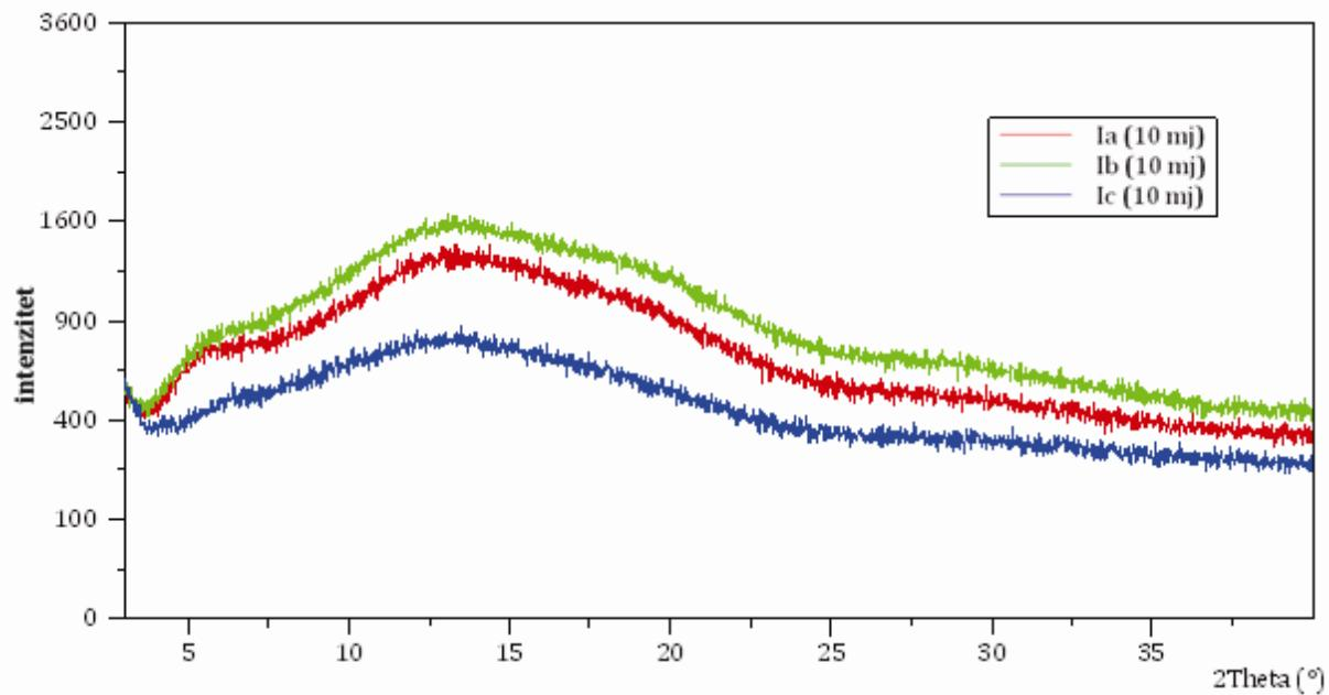
**Slika 5 - 24.** Difraktogram mikročestica s omjerom lijeka i polimera 1 : 5 ( $m/m$ ) sušenih raspršivanjem iz a) metanola; b) metanol-etanolske smjese (50 : 50,  $m/m$ ) i c) aceton-izopropanske smjese (40 : 60,  $m/m$ ) nakon deset mjeseci uskladištenja na 25 °C/60%RV
