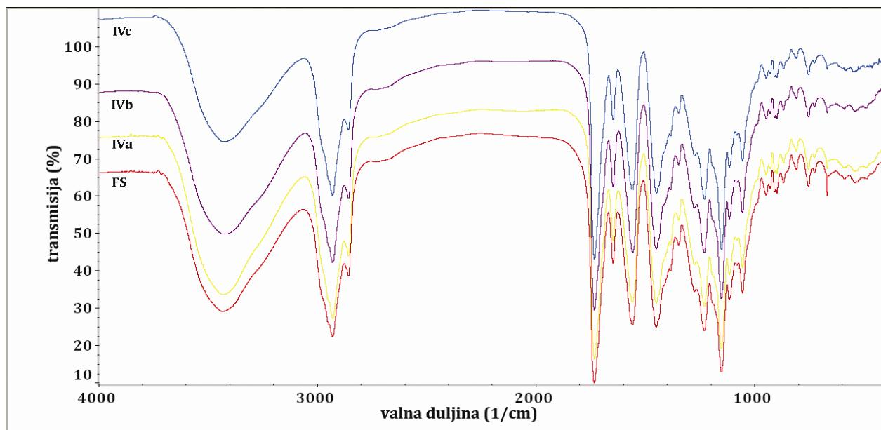
**Slika 5 – 21.** FTIR spektri mikročestica s omjerom lijeka i polimera  $2 : 1$  ( $m/m$ ) sušenih raspršivanjem iz a) metanola; b) metanol-etanolske smjese ( $50 : 50$ ,  $m/m$ ) i c) aceton-izopropansko-smjese ( $40 : 60$ ,  $m/m$ ) u usporedbi s fizičkim smjesama (FS) lijeka i polimera
