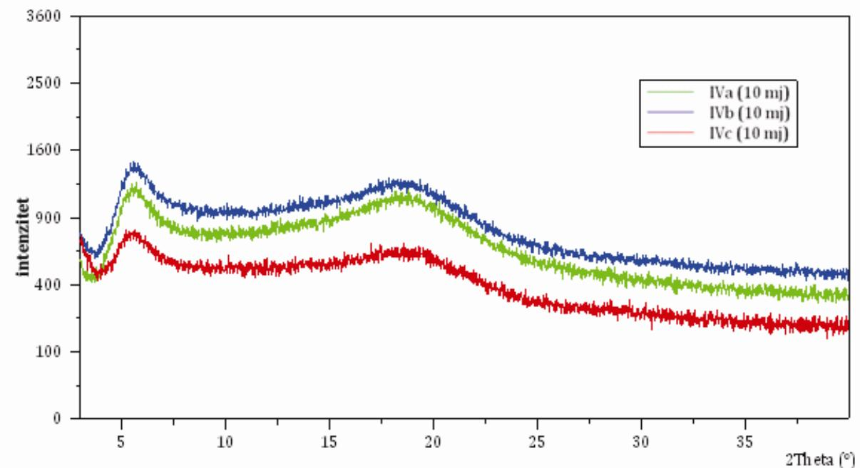
**Slika 5 - 25.** Difraktogram mikročestica s omjerom lijeka i polimera 2 : 1 ( $m/m$ ) sušenih raspršivanjem iz a) metanola; b) metanol-etanolske smjese (50 : 50,  $m/m$ ) i c) aceton-izopropanske smjese (40 : 60,  $m/m$ ) nakon deset mjeseci uskladištenja na 25 °C/60%RV
