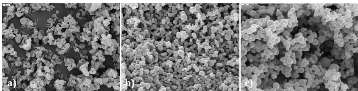
**Slika 5 – 16.** SEM slike mikročestica s omjerom lijeka i polimera 1 : 5 ( $m/m$ ) sušenih raspršivanjem iz a) metanola; b) metanol-etanolske smjese (50 : 50,  $m/m$ ) i c) aceton-izopropanolske smjese (40 : 60,  $m/m$ )
