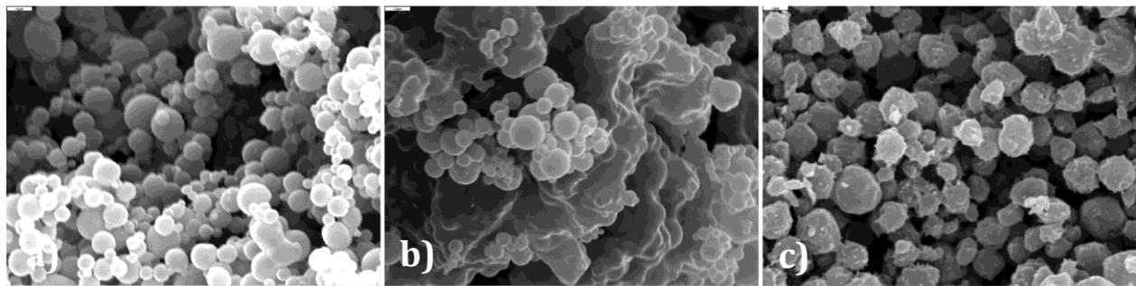
**Slika 5 – 29.** SEM slike mikročestica s omjerom lijeka i polimera 1 : 5 ( $m/m$ ) (a – b) i 2 : 1 ( $m/m$ ) (c) sušenih raspršivanjem iz vodene smjese (polimer u disperznom stanju) (skala označava 2  $\mu\text{m}$ )
