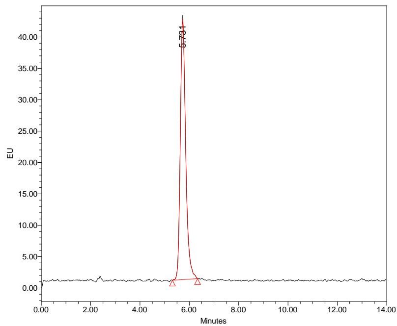
**Slika 11.** Kromatogram standarda MDA koncentracije 0,3 μmol/L
