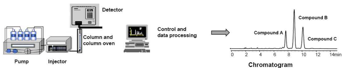
Slika 2. Prikaz kromatografskog sustava HPLC (16).
