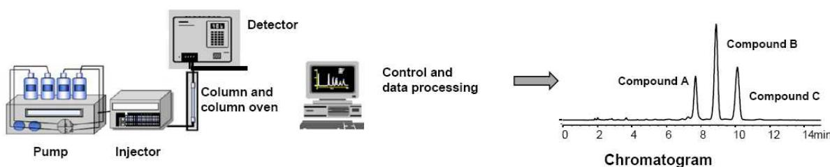
*Slika 2. Prikaz kromatografskog sustava HPLC (16).*
