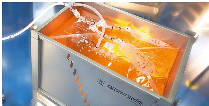
Slika 10 – Primjer jednokratne opreme – vreća za kultivaciju (preuzeto iz 44).
