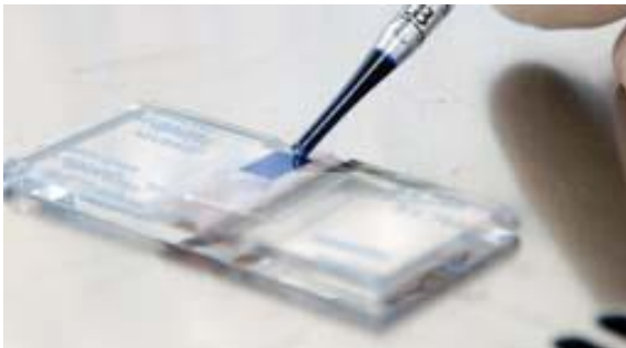
Slika 6. Prikaz stavljanja uzorka automatskom pipetom (preuzeto prema: http://www.sigmaaldrich.com/technical-documents/protocols/biology/cell-quantification.html ).
