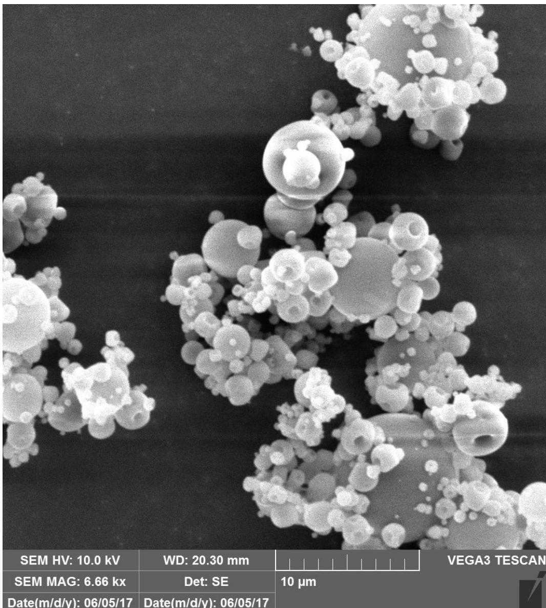
**Slika 11.** SEM mikrografija alginatnih mikročestica (povećanje  $6660 \times$ ) pripravljenih sušenjem raspršivanjem otopine natrijevog alginata (0,5 %, *m/V*) pri brzini dotoka uzorka od 3,92 g/min, radu aspiratora na 25% kapaciteta, ulaznoj temperaturi sušenja  $140^{\circ}\text{C}$  i protoku komprimiranog zraka od 700 Nl/h.
