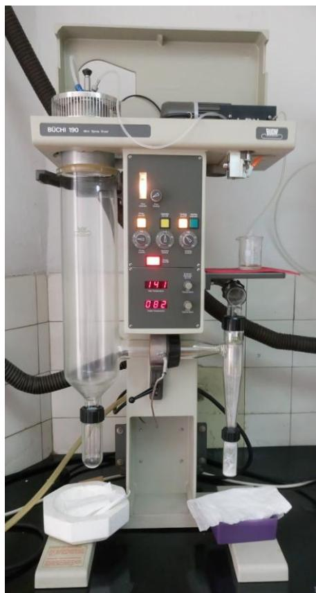
Slika 3. Uredaj za sušenje raspršivanjem Büchi 190 Mini Spray Dryer
