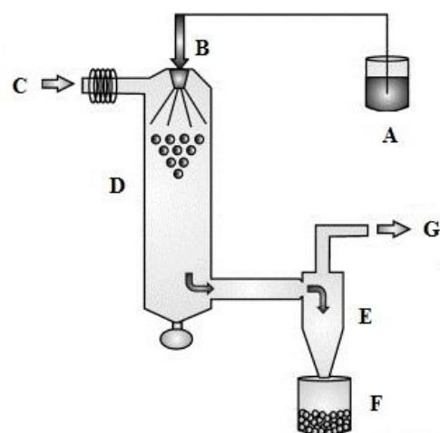
**Slika 1:** Shema uređaja za sušenje raspršivanjem (A – uzorak, B – sapnica, C – medij (plin) za sušenje, D – komora za sušenje, E – ciklon, F – prihvativa posuda za produkt, G – ispušni ventil) (prilagođeno prema Sosnik i Seremeta, 2015)
