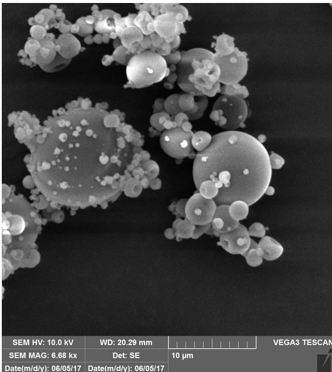
**Slika 12.** SEM mikrografija alginatnih mikročestica (povećanje  $6680 \times$ ) pripravljenih sušenjem raspršivanjem otopine natrijevog alginata ( $0,5\%, m/V$ ) pri brzini dotoka uzorka od  $3,92\text{ g/min}$ , radu aspiratora na  $25\%$  kapaciteta, ulaznoj temperaturi susenja  $140^\circ\text{C}$  i protoku komprimiranog zraka od  $700\text{ Nl/h}$ .
