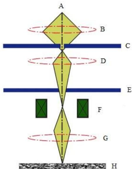
**Slika 6.** Shema pretražne elektronske mikroskopije (A - izvor elektrona, B, D – kondenzirajuće leće, C, E – apertura objektiva, F – skenirajuće (pretražne) zavojnice, G – leća objektiva, H – predmetno stakalce, odnosno uzorak) (prilagođeno prema [www.nanoscience.com](http://www.nanoscience.com))
