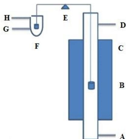
**Slika 7.** Shema uređaja za termogravimetriju (A – ulaz plina u komoru s uzorkom, B – uzorak, C – pećnica, D – ispuh plina iz komore s uzorkom, E – elektrovaga, F – uteg, G – ulaz plina u komoru s utegom, H – ispuh plina iz komore s utegom) (prilagođeno prema Greers, 2013)
