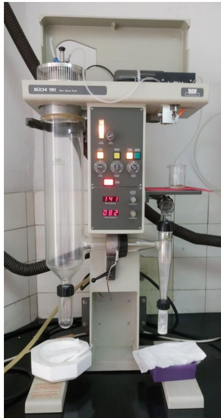
Slika 3. Uređaj za sušenje raspršivanjem Büchi 190 Mini Spray Dryer
